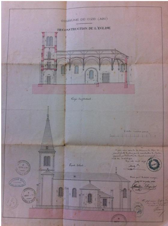
Figure 2 Plan de la façade latérale et coupe longitudinale de l'église, 2M1 (1878).
