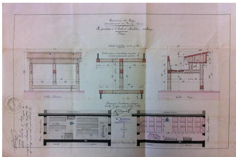
Figure 4 Plan de la salle de classe et dessins des tables d'écoliers, 4M1 (1889).
